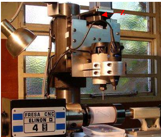
Figura1. Fresadora a CNC de 4 ejes ELINON 0 .
